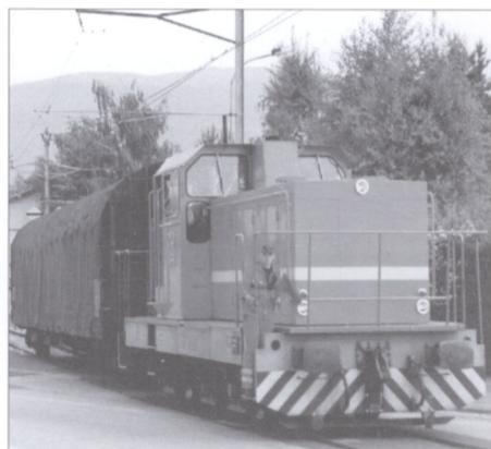
Mit der Em 3/3 3 verfügt die OC seit 1985 auch über ein fahrdrahtunabhängiges Triebfahrzeug (Les Granges, 26.5.98; Foto M. Klausner).
